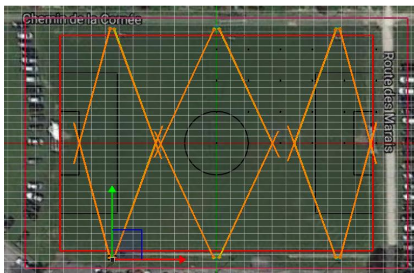
Simulation : ajustement des luminaires et direction des flux
