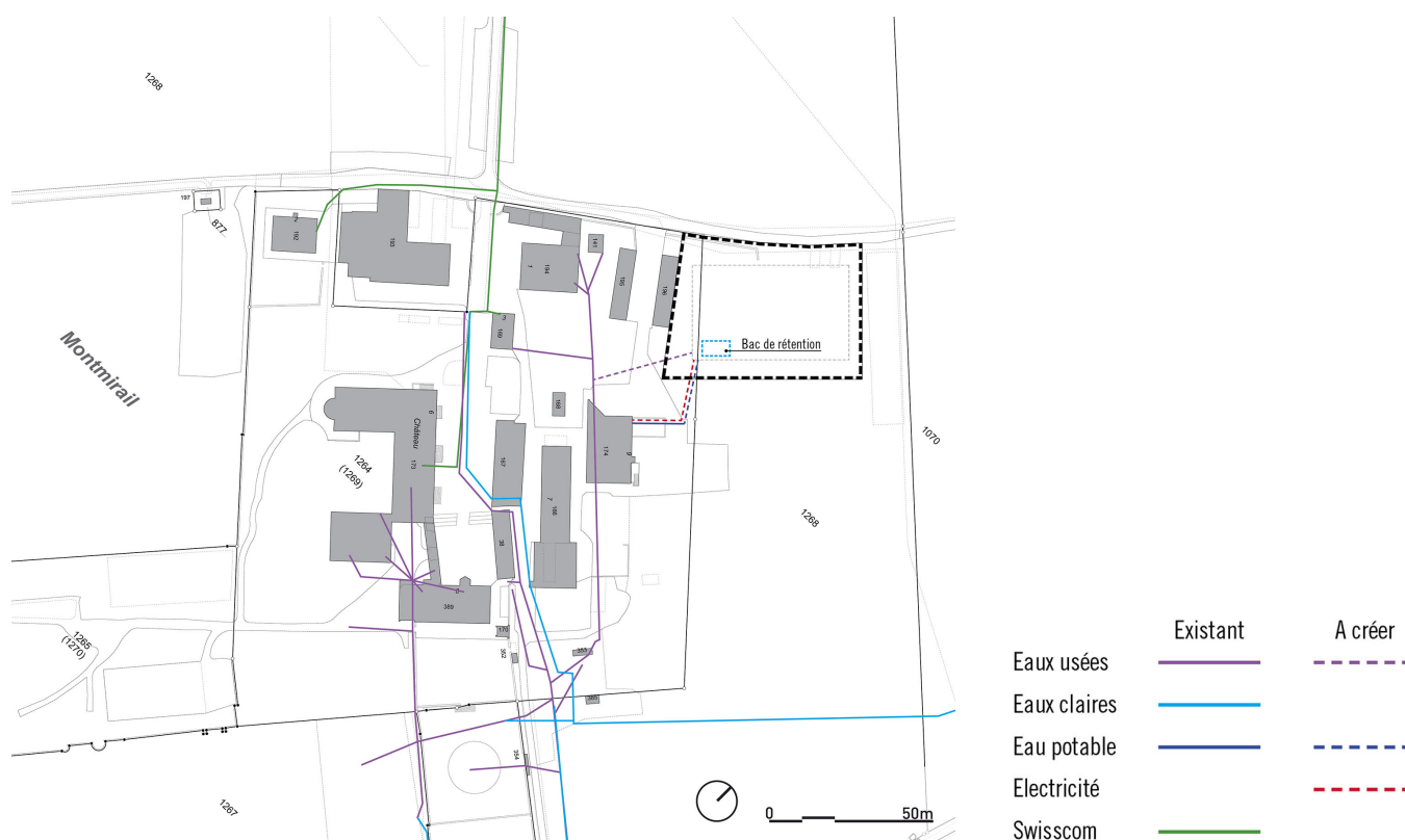
Fig. 12 : Équipements existants (source fond : ©SITN, 2019)
