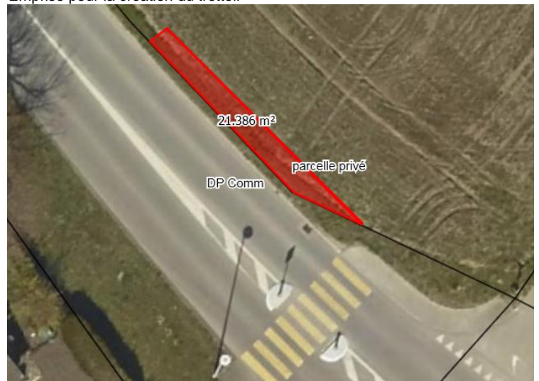
Emprise pour la création du trottoir
